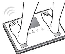
2. Les données de mesure sont automatiquement envoyées au smartphone. Si des données non envoyées sont stockées dans l'analyseur, elles sont également envoyées au smartphone.
